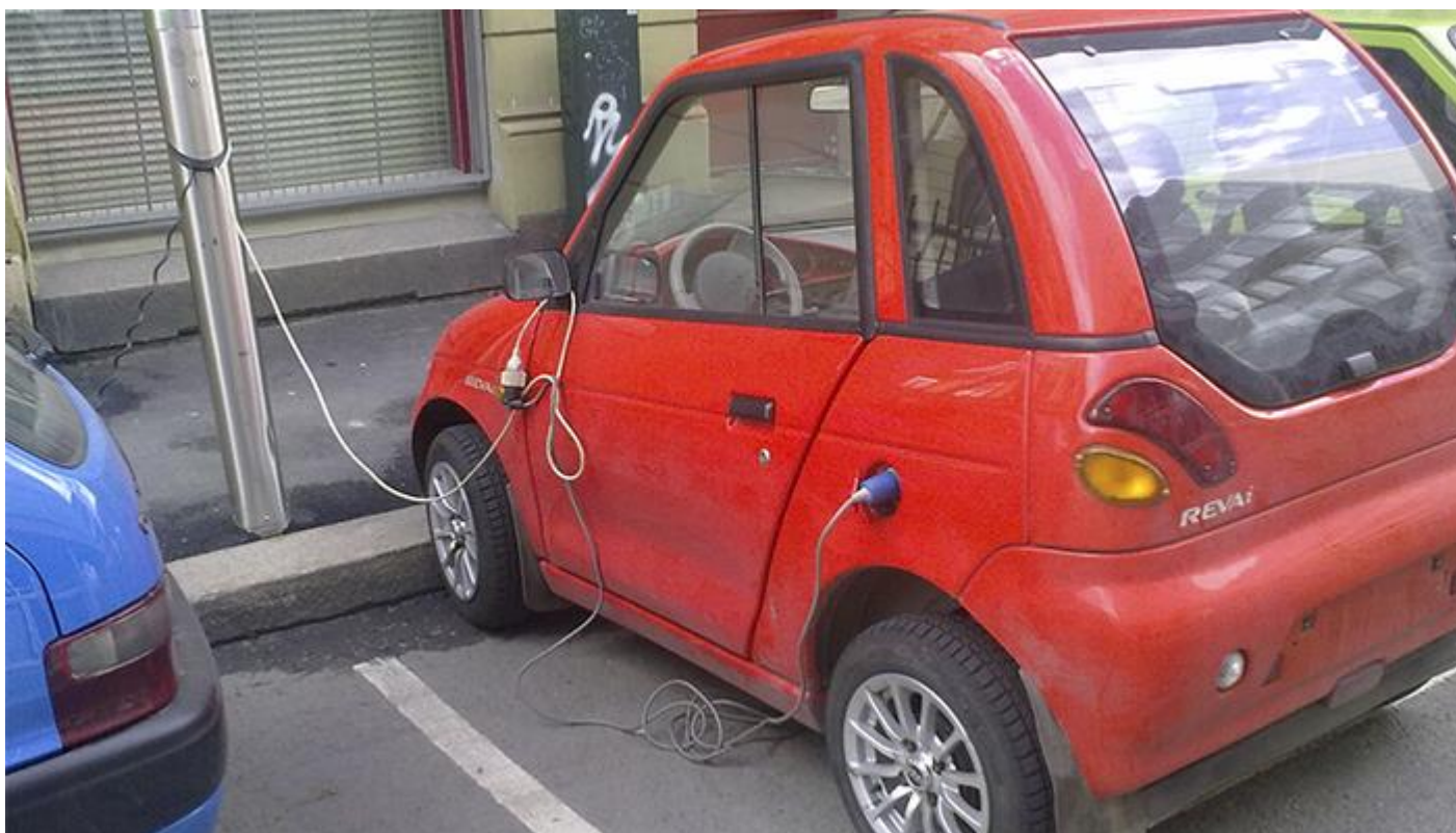
Skjøteledning på ladekabel (Foto: Jostein Grav/DSB)
