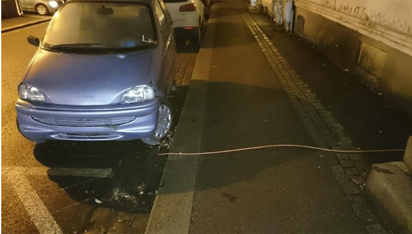
Elbil med kabel over fortau, langs vegg og inn vindu (Foto: Jostein Grav/DSB)
