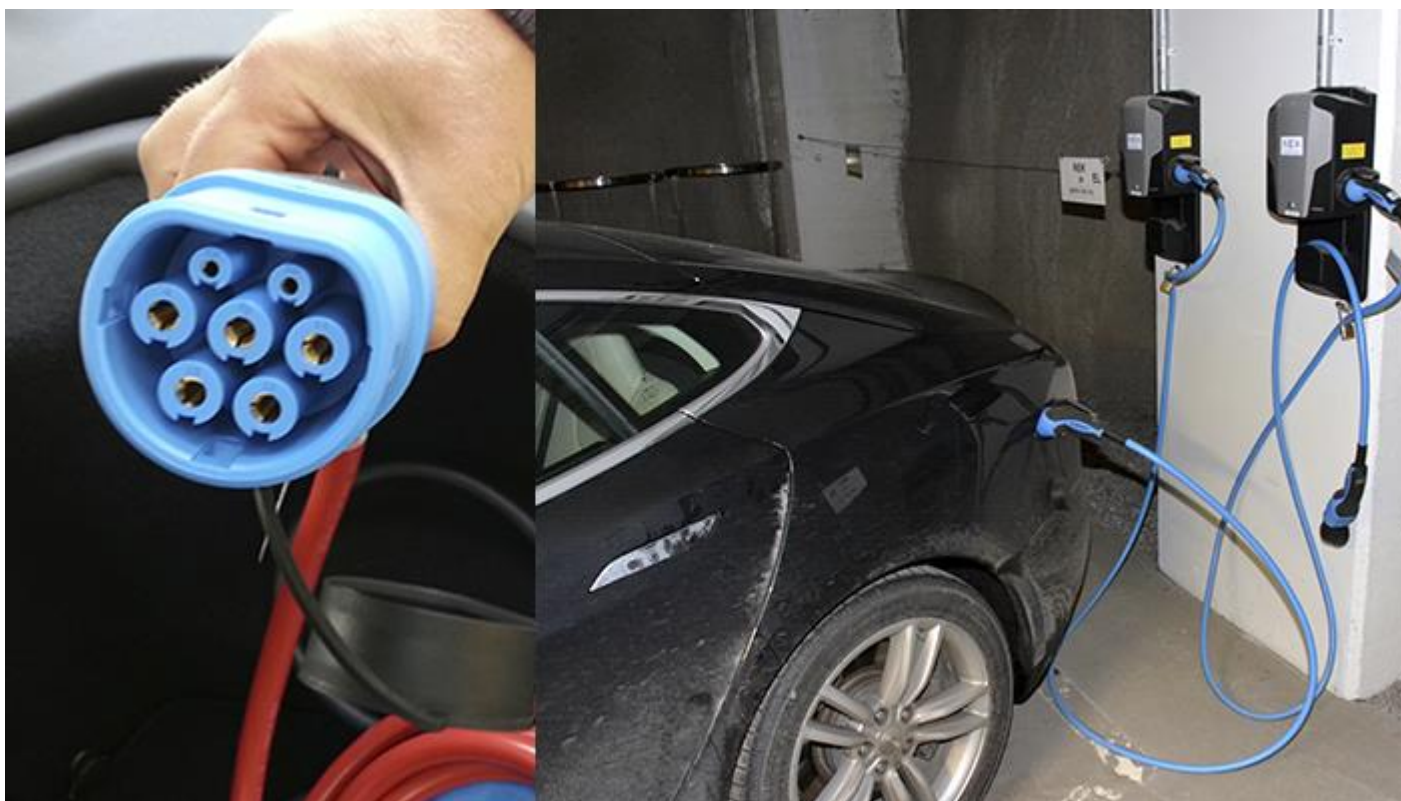
Fra venstre: Type 2 kontakt (Mennekes kontakt) og bil til mode 3 lading med løs type 2 kabel. (Foto: Jostein Grav/DSB og Leif T. Aanesen/NEK)
