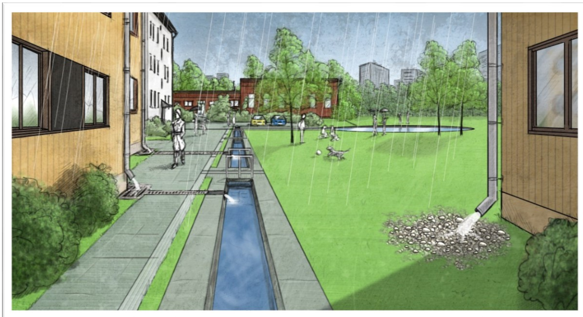
Figur 3 Illustrasjonen over viser et eksempel på hvordan man kan håndtere overvann lokalt slik at det både er et funksjonelt tiltak samtidig som et estetisk element i gårdsrommet. Til høyre i bildet føres vann fra tak til terreng slik at vannet kan infiltreres i bakken. Til venstre i bildet ledes takvannet ut i en kanal som ender i en større dam bakerst i bildet.
