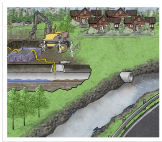
Figur 6 viser et eksempel på feil håndtering av overvann fra anleggsvirksomhet.
