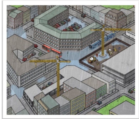
Figur 1 Illustrasjonene over viser resultatet av at overvannshåndteringen ikke er inkludert i reguleringsplanleggingen. Det er ikke avsatt områder til å håndtere nedbøren. Alt overvannet ledes dermed inn på det offentlige avløpssystemet. Avløpssystemet har ikke kapasitet til å ta unna alt vannet og bygatene oversvømmes av vann. Trafikken stanser og vi får store og kostbare skader både på veinettet og de omliggende eiendommene.
