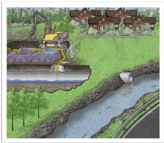
Figur 5 viser et eksempel på god håndtering av overvann fra anleggsvirksomhet.
