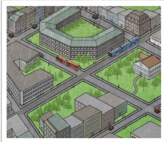
Figur 2 Gode overvannsløsninger krever både plass og planlegging. Illustrasjonene ovenfor viser eksempel hvor overvannshåndteringen er inkludert i reguleringsplanleggingen. Her er det avsatt plass til grønne arealer og fordøyning i terrenget slik at vi kan ta vare på vannet på stedet når det regner. Samtidig opprettholder vi trafikkflyten og unngår skader på eiendommer og infrastruktur. Når alt dette er planlagt for, blir byggesaksbehandlingen enklere både for utbyggeren og de offentlige saksbehandlere.
