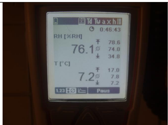
Bilde 12. Resultat av 46 min logging av luftfuktighet i garasjeanlegg (v/ oppgang til nr 78) ettermiddag/ kveld 29.01.19.
