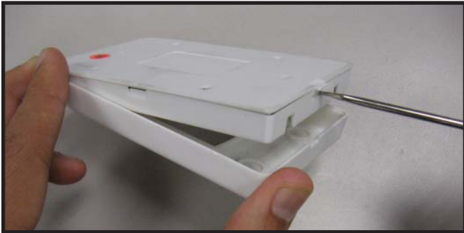
Figur 1 Demontering av veggbryteren
